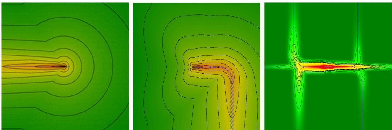
Abbildung 24: Überlagerung von Basis-Immissionsgittern. Dargestellt sind Maximalpegel-Basisgitter für eine An- (links) und Abflugstrecke (Mitte) sowie das Resultat einer Überlagerung von 72 Maximalpegelgittern zu einem Gitter (rechts), das Aufwachreaktionen beschreibt (siehe Abschnitt 5.1.4.4). (Quelle: eigene Darstellung, erzeugt aus grafischen Ergebnissen von NMPLLOT [44], DLR)
