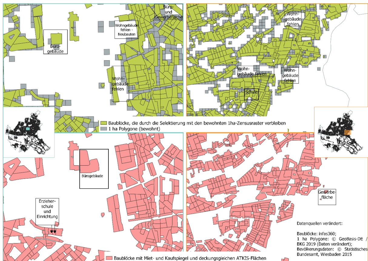
Abbildung 13: Korrekturverfahren für infas360-Baublöcke mit Miet- und Kaufspiegeldaten - oben: Ergebnis des Abgleichs mit bewohnten 100 x 100 m 2 Zensusrasterzellen; unten: Ergebnis des Abgleichs mit ATKIS-Flächen
