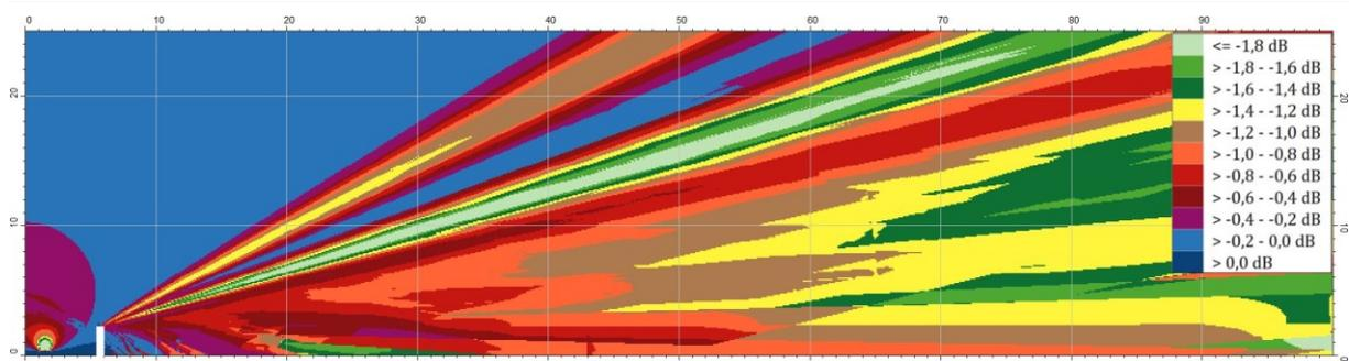
Änderung der Immissionspegel durch die Höhe des Emissionsbandes von 0,05 m nach der BUB gegenüber 0,5 m nach den übrigen Berechnungsvorschriften. Eine Lärmschutzwand mit einer Höhe von 2 m steht in 2,5 m Abstand zum Fahrbahnrand (weiße Markierung). Dargestellt ist ein 0,1-m-Raster gemäß BUB in bis zu 25 m Höhe und 100 m Entfernung. Die Mitte der Straße befindet sich am linken Bildrand.
