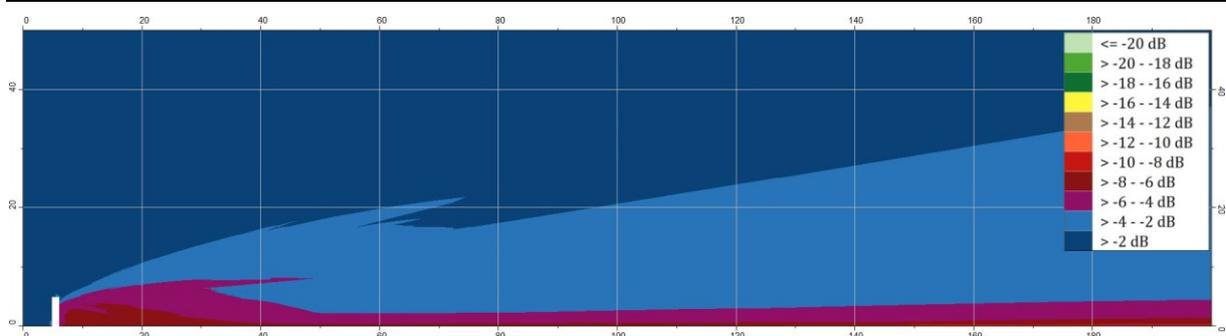
Differenz der Immissionspegel zwischen  $G=1$  (schallharter Boden) und  $G=0$  (schallweicher Boden) nach der BUB. Dargestellt ist ein Raster mit der horizontalen Auflösung 1m und vertikalen Auflösung 0,1m in bis zu 50 m Höhe und 200 m Entfernung mit einer 4 m Lärmschutzwand in 5,5 m Entfernung zur Mittelachse der Straße. Die Mitte der Straße befindet sich am linken Bildrand.
