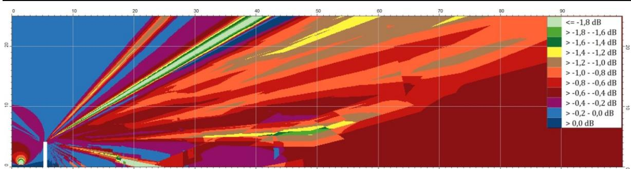
Änderung der Immissionspegel durch die Höhe des Emissionsbandes von 0,05 m nach der BUB gegenüber 0,5 m nach den übrigen Berechnungsvorschriften. Eine Lärmschutzwand mit einer Höhe von 4 m steht in 2,5 m Abstand zum Fahrbahnrand (weiße Markierung). Dargestellt ist ein 0,1-m-Raster gemäß BUB in bis zu 25 m Höhe und 100 m Entfernung. Die Mitte der Straße befindet sich am linken Bildrand. Quelle: LÄRMKONTOR GmbH
