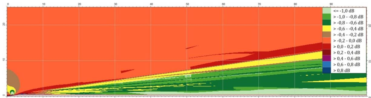
Änderung der Immissionspegel durch die Höhe des Emissionsbandes von 0,05 m nach der BUB gegenüber 0,5 m nach den übrigen Berechnungsvorschriften. Das Gelände steigt bis in 3 m Entfernung zur Straßenachse auf 0,5 m an. Dargestellt ist ein 0,1-m-Raster gemäß BUB in bis zu 25 m Höhe und 100 m Entfernung. Die Mitte der Straße befindet sich am linken Bildrand.
