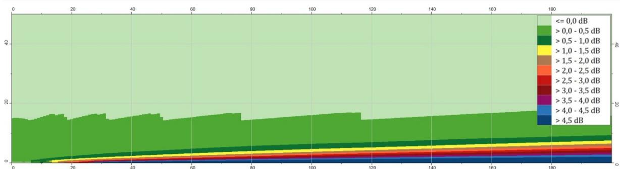
Differenz der Immissionspegel zwischen günstigen und homogenen Ausbreitungsbedingungen mit  $G=0$  (schallweicher Boden) nach der BUB. Dargestellt ist ein 0,1-m-Raster in bis zu 50 m Höhe und 200 m Entfernung bei freier Schallausbreitung. Die Mitte der Straße befindet sich am linken Bildrand. Quelle: LÄRMKONTOR GmbH
