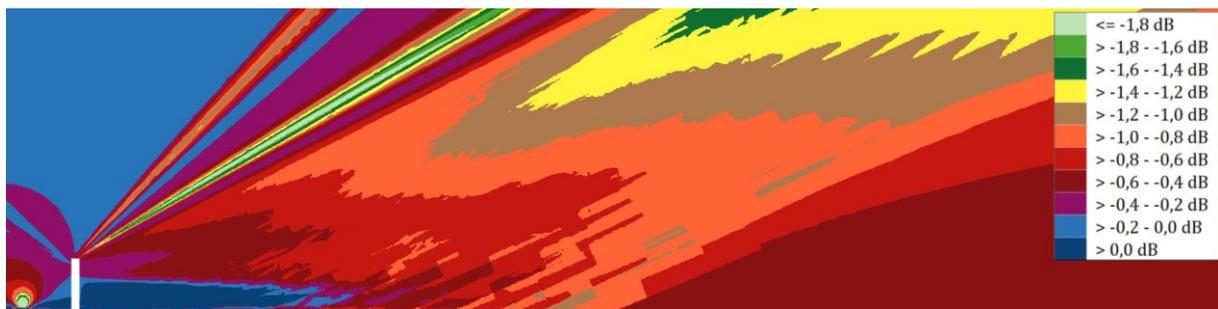
Änderung der Immissionspegel durch die Höhe des Emissionsbandes von 0,05 m nach der BUB gegenüber 0,5 m nach den übrigen Berechnungsvorschriften. Eine Lärmschutzwand mit einer Höhe von 4 m steht in 2,5 m Abstand zum Fahrbahnrand (weiße Markierung). Dargestellt ist ein 0,1-m-Raster gemäß BUB in bis zu 25 m Höhe und 100 m Entfernung. Die Mitte der Straße befindet sich am linken Bildrand. Berechnet wurde mit SoundPLAN 8.2. Quelle: LÄRMKONTOR GmbH
