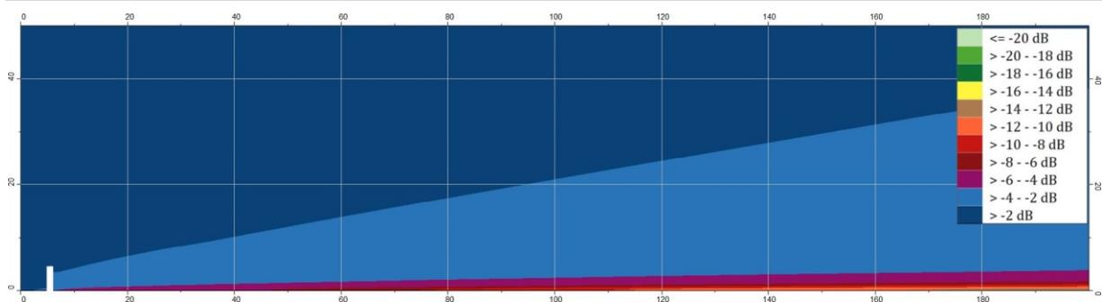
Differenz der Immissionspegel zwischen  $G=1$  (schallharter Boden) und  $G=0$  (schallweicher Boden) nach der BUB. Dargestellt ist ein 0,1-m-Raster in bis zu 50 m Höhe und 200 m Entfernung mit einer 4 m Lärmschutzwand in 5,5 m Entfernung zur Mittelachse der Straße. Die Mitte der Straße befindet sich am linken Bildrand.
