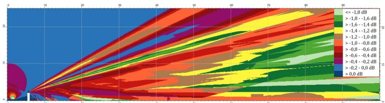
Änderung der Immissionspegel durch die Höhe des Emissionsbandes von 0,05 m nach der BUB gegenüber 0,5 m nach den übrigen Berechnungsvorschriften. Eine Lärmschutzwand mit einer Höhe von 2 m steht in 2,5 m Abstand zum Fahrbahnrand (weiße Markierung). Dargestellt ist ein 0,1-m-Raster gemäß BUB in bis zu 25 m Höhe und 100 m Entfernung. Die Mitte der Straße befindet sich am linken Bildrand. Quelle: LÄRMKONTOR GmbH
