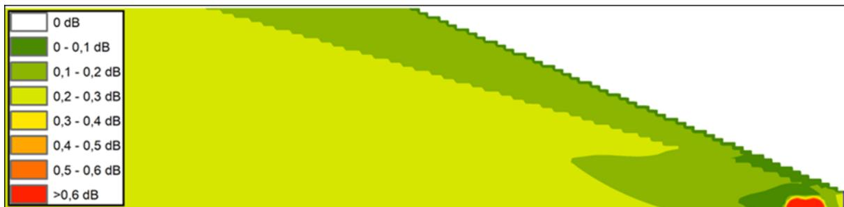
Änderung der Immissionen durch die Änderung der Korrekturen für die Absorption/den Reflexionsverlust. Dargestellt ist ein 0,1-m-Differenzraster in bis zu 50 m Höhe und 200 m Entfernung bei freier Schallausbreitung (RLS-19 minus RLS-90), bei dem 50 m über der Straße die Differenz 0 dB beträgt. Die Straße befindet sich rechts im Bild. Die blaue Markierung rechts kennzeichnet eine Lärmschutzwand in 10 m Entfernung zur Mittelachse der Straße. Quelle: LÄRMKONTOR GmbH
