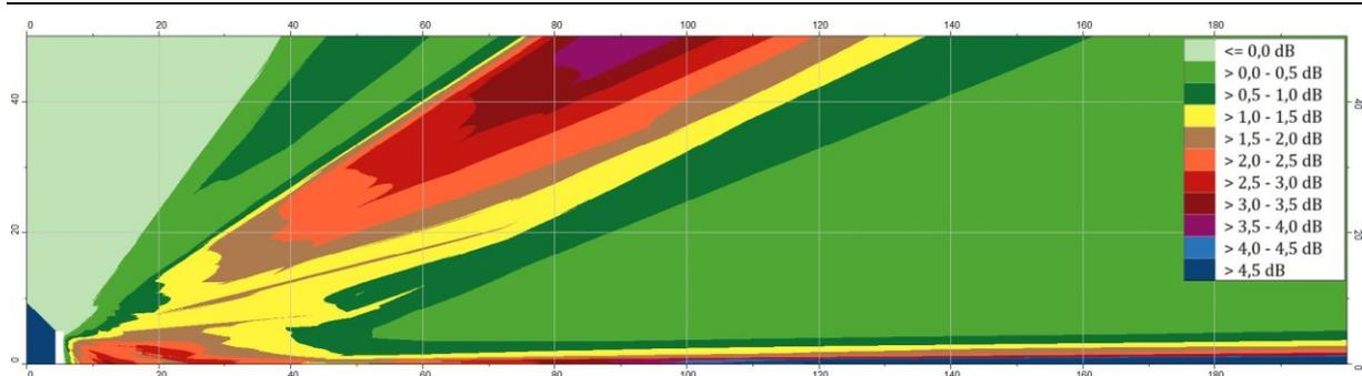
Differenz der Immissionspegel günstigen und homogenen Ausbreitungsbedingungen mit  $G=1$  (schallharter Boden) nach der BUB. Dargestellt ist ein Raster mit der horizontalen Auflösung 1 m und vertikalen Auflösung 0,1 m in bis zu 50 m Höhe und 200 m Entfernung mit einer 4 m Lärmschutzwand in 5,5 m Entfernung zur Mittelachse der Straße. Die Mitte der Straße befindet sich am linken Bildrand. Quelle: LÄRMKONTOR GmbH
