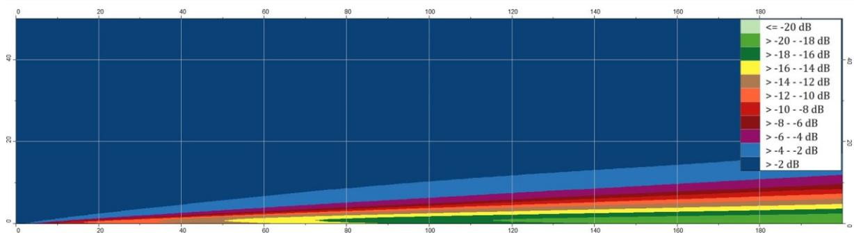
Differenz der Immissionspegel zwischen  $G=1$  (schallharter Boden) und  $G=0$  (weicher Boden) nach der BUB. Dargestellt ist ein 0,1-m-Raster in bis zu 50 m Höhe und 200 m Entfernung bei freier Schallausbreitung. Die Mitte der Straße befindet sich am linken Bildrand. Quelle: LÄRMKONTOR GmbH
