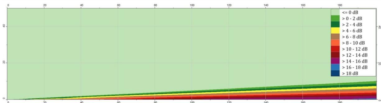
Differenz der Immissionspegel günstigen und homogenen Ausbreitungsbedingungen mit  $G=1$  (schallharter Boden) nach der BUB. Dargestellt ist ein Raster mit der horizontalen Auflösung 1 m und vertikalen Auflösung 0,1 m in bis zu 50 m Höhe und 200 m Entfernung bei freier Schallausbreitung. Die Mitte der Straße befindet sich am linken Bildrand.
