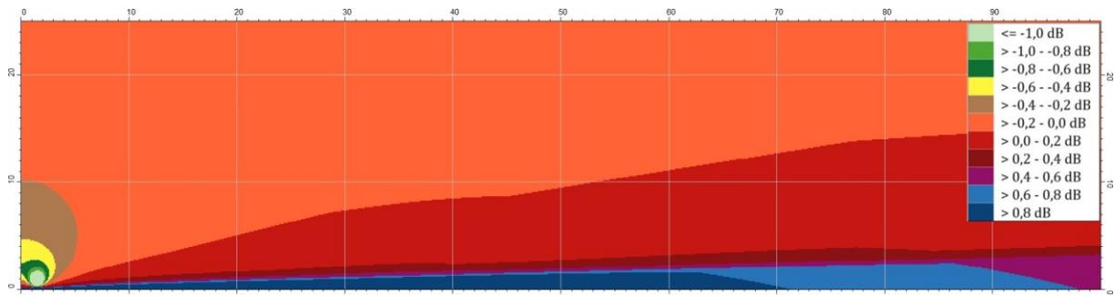
Änderung der Immissionspegel durch die Höhe des Emissionsbandes von 0,05 m nach der BUB gegenüber 0,5 m nach den übrigen Berechnungsvorschriften. Dargestellt ist ein 0,1-m-Raster gemäß BUB in bis zu 25 m Höhe und 100 m Entfernung bei freier Schallausbreitung. Die Mitte der Straße befindet sich am linken Bildrand. Quelle: LÄRMKONTOR GmbH
