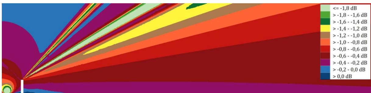
Änderung der Immissionspegel durch die Höhe des Emissionsbandes von 0,05 m nach der BUB gegenüber 0,5 m nach den übrigen Berechnungsvorschriften. Eine Lärmschutzwand mit einer Höhe von 4 m steht in 2,5 m Abstand zum Fahrbahnrand (weiße Markierung). Dargestellt ist ein 0,1-m-Raster gemäß BUB in bis zu 25 m Höhe und 100 m Entfernung. Die Mitte der Straße befindet sich am linken Bildrand. Berechnet wurde mit SoundPLAN 8.2. Quelle: LÄRMKONTOR GmbH
