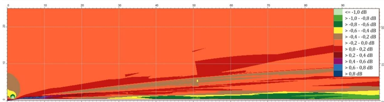
Änderung der Immissionspegel durch die Höhe des Emissionsbandes von 0,05 m nach der BUB gegenüber 0,5 m nach den übrigen Berechnungsvorschriften. Das Gelände steigt bis in 3 m Entfernung zur Straßenachse auf 0,5 m an. Dargestellt ist ein 0,1-m-Raster gemäß BUB in bis zu 25 m Höhe und 100 m Entfernung. Die Mitte der Straße befindet sich am linken Bildrand.
