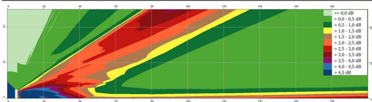
Differenz der Immissionspegel zwischen günstigen und homogenen Ausbreitungsbedingungen mit  $G=0$  (schallweicher Boden) nach der BUB. Dargestellt ist ein Raster mit der horizontalen Auflösung 1m und vertikalen Auflösung 0,1m in bis zu 50 m Höhe und 200 m Entfernung mit einer 4 m Lärmschutzwand in 5,5 m Entfernung zur Mittelachse der Straße. Die Mitte der Straße befindet sich am linken Bildrand. Quelle: LÄRMKONTOR GmbH
