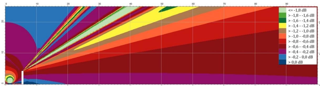
Änderung der Immissionspegel durch die Höhe des Emissionsbandes von 0,05 m nach der BUB gegenüber 0,5 m nach den übrigen Berechnungsvorschriften. Eine Lärmschutzwand mit einer Höhe von 4 m steht in 2,5 m Abstand zum Fahrbahnrand (weiße Markierung). Dargestellt ist ein 0,1-m-Raster gemäß BUB in bis zu 25 m Höhe und 100 m Entfernung. Die Mitte der Straße befindet sich am linken Bildrand. Berechnet wurde mit IMMI 2020. Quelle: LÄRMKONTOR GmbH
