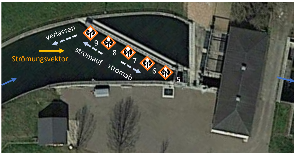
Abbildung 3: Anordnung der Radiotelemetrieantennen vor dem Leitreechen der WKA und Veranschaulichung der definierten Bewegungsrichtung
