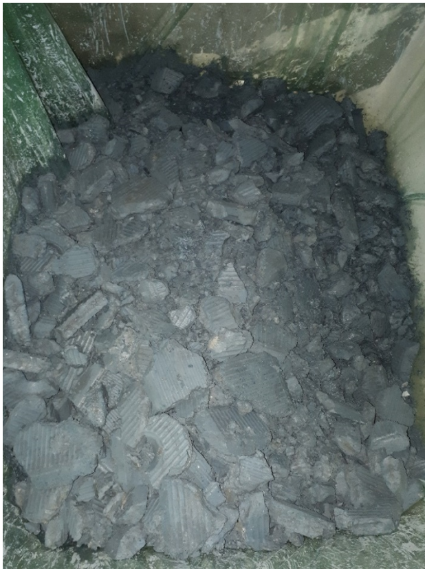
Abbildung 19: 6:2 FTS- und Chrom-III-haltiger Metallhydroxidschlamm
