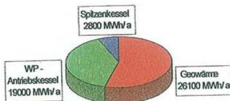
Gesamtenergieeinsatz: 47.900 MWh/a, davon 54 % Geowärme
