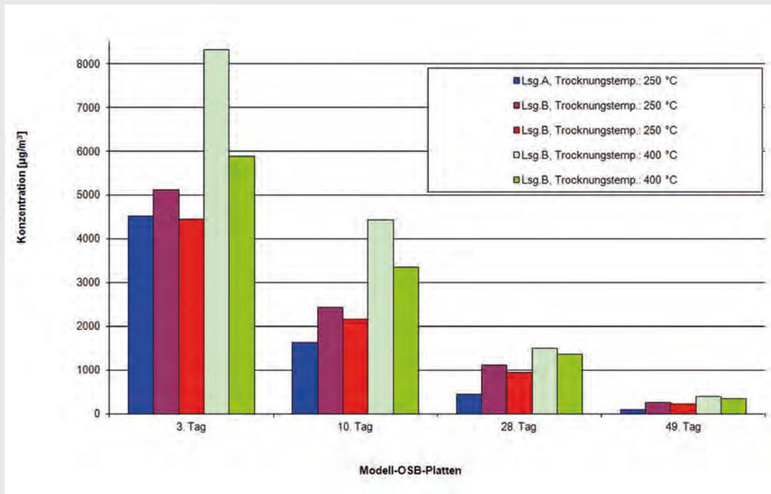
Hexanal-Emission wurde um circa zwei Drittel auf ein Drittel der Vergleichsprobe reduziert. Die mit Lösung B behandelten Platten zeigten zu keinem Zeitpunkt der Untersuchung eine höhere Konzentration an Hexanal. Die Behandlung mit Lösung B erbrachte also eine Reduzierung und nicht nur eine zeitliche Verzögerung der Aldehyd-Emissionen.
