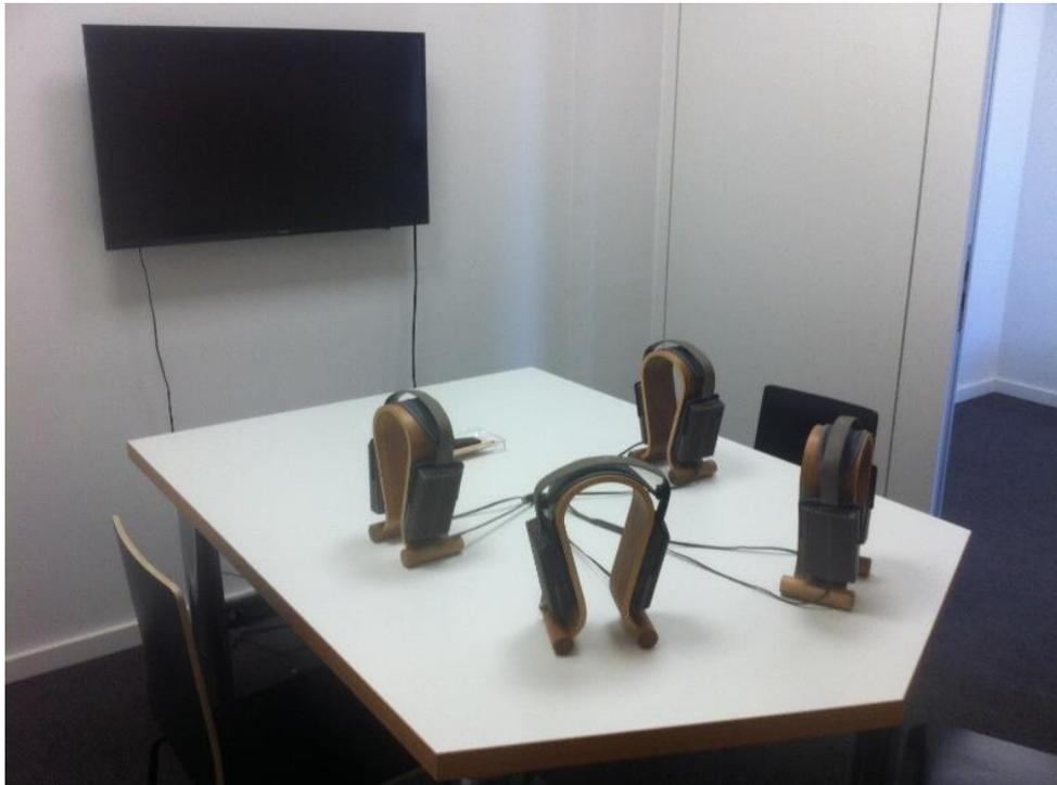
In einer ersten Hörversuchsreihe lag der Fokus auf der grundsätzlichen Unterscheidung eines Flachstellensignals zwischen „akzeptabel“ und „nicht akzeptabel“. In einer weiteren Hörversuchsreihe sollte anhand von repräsentativen Signalen mit Flachstellen direkt eine Beurteilung der Lästigkeit dieser Signale erfolgen. Quelle: eigene Darstellung, Möhler + Partner Ingenieure AG
