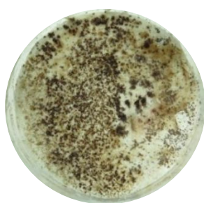
Abbildung 8: Farbe 2 nach künstlicher Alterung und Belastungstest mit Schimmelsporen im Prüfgebilde (Öffnungsdurchmesser 62 mm)
