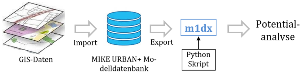
Abbildung 9: Die vier Bearbeitungsschritte für den Einsatz der Simulationssoftware
