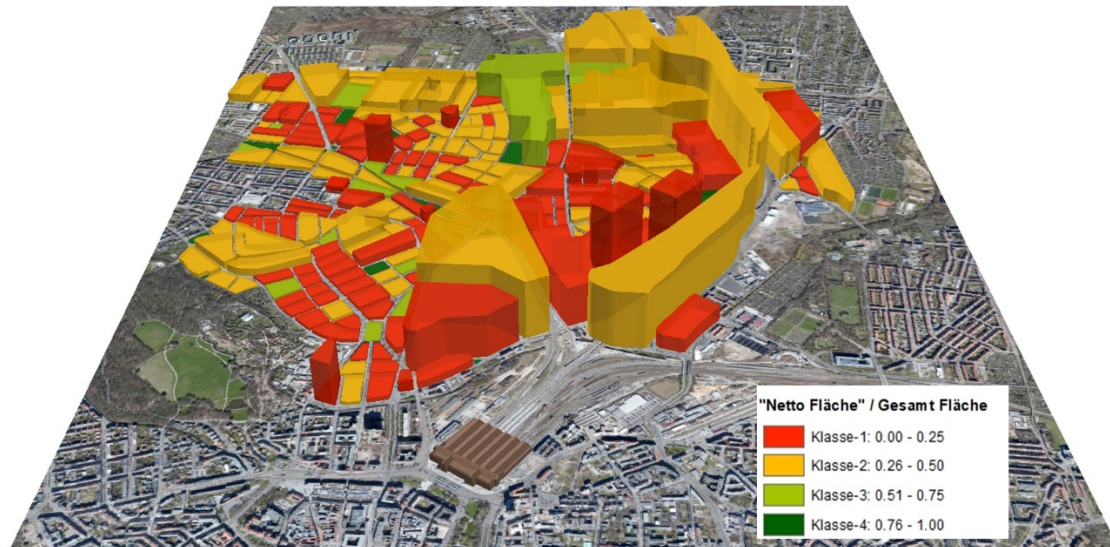
Abbildung 13: Modellierter „Ist-Situation“ (0-SZ30-4) des Oberflächenabflusses auf Häuserblockebene bei einem 30-jährigen Niederschlagsereignis und gut durchlässigem Boden ( k_f=10^{-4} m/s)
