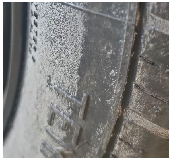
Abbildung 28 Durch Verformung ausgetretene Alterungsschutzmittel eines Reifens
