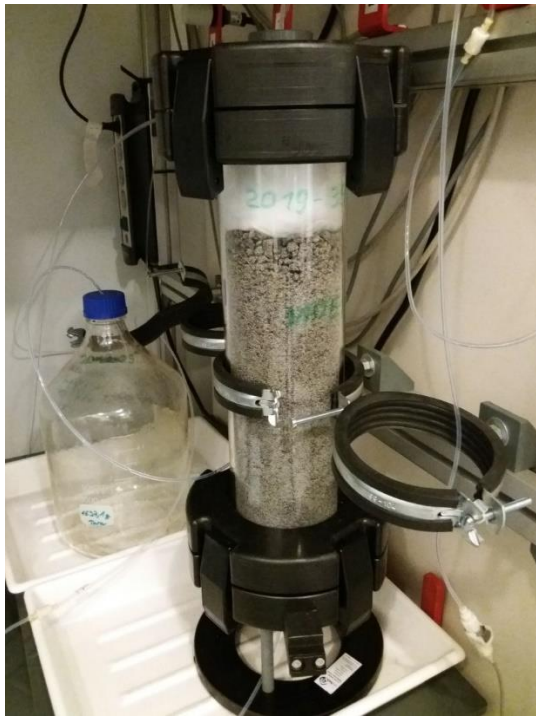
Abbildung 8: Für den Perkolationstest vorbereitete Säule mit dem Pflasterfugenmörtel MOE1
