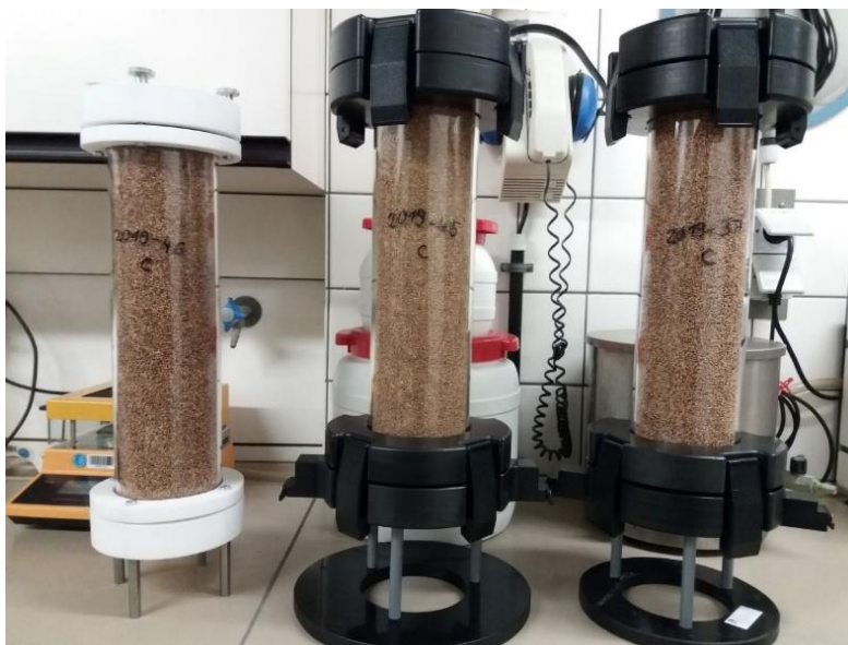
Abbildung 9: Für den Perkolationstest vorbereitete Säule mit den Korkgranulaten
