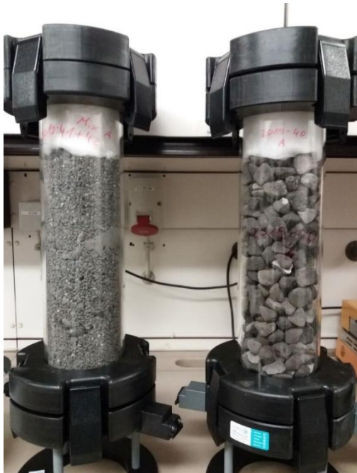
Abbildung 10: Für den Perkolationstest vorbereitete Säule mit den Schaumglasschottern
