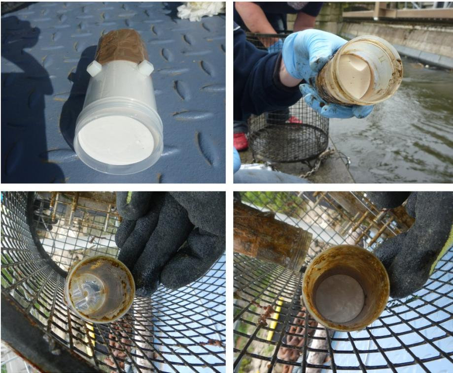
Die Abbildungen oben zeigen Gipskartuschen vor der Exposition (links) und nach der Exposition in einem Gewässer mit mittlerer Fließgeschwindigkeit (rechts). Die Fotos unten zeigen die Befestigung von Gipskartuschen an den Ausbringvorrichtungen für Passivsammler nach der Exposition im Rhein bei hoher Fließgeschwindigkeit. In dem Bild unten links ist zudem eine Gipskartusche abgebildet, aus der während der Exposition der Gips vollständig ausgespült wurde. Quelle: eigene Fotos, BfG
