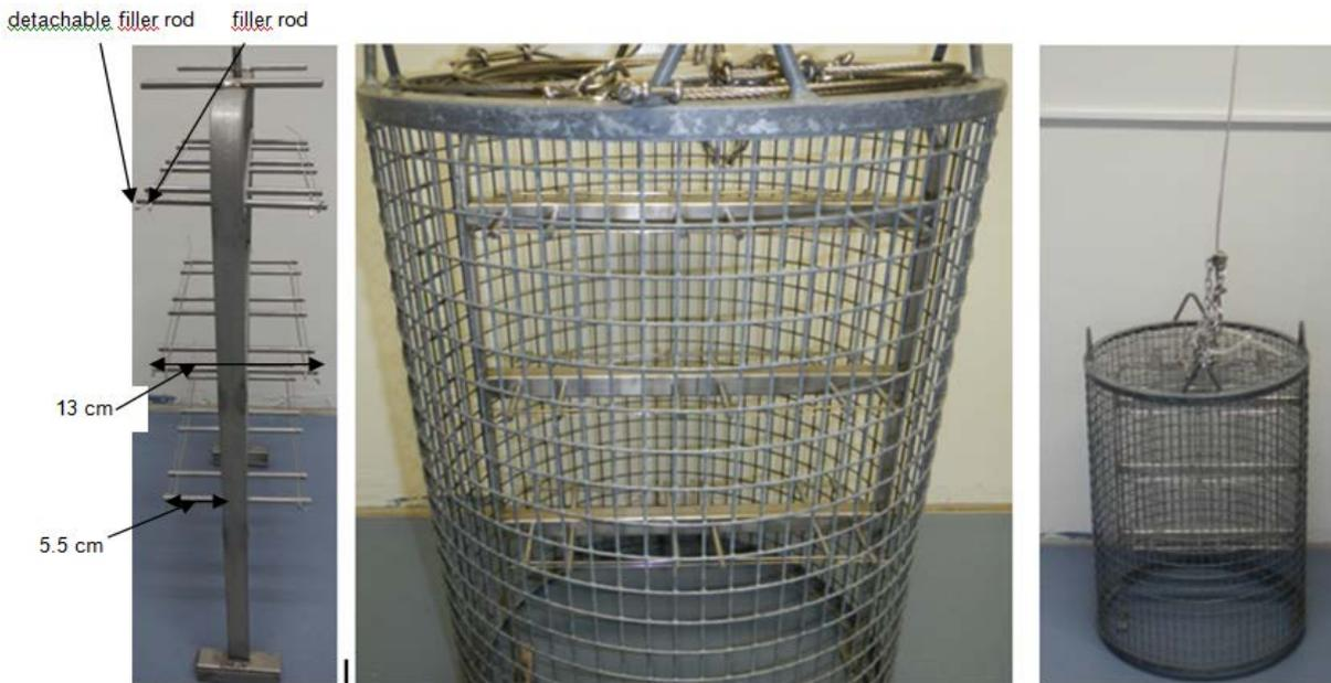
Bild links: Edelstahlgestänge für die Befestigung von bis zu 18 Silikonstreifen. Abnehmbare Schweißdrähte dienen der Befestigung auf Edelstahlstäben während der Exposition im Gewässer, Bild Mitte: ein Edelstahlkorb schützt das Edelstahlgestänge mitsamt Passivsammlern, Bild rechts: ein Edelstahlkorb mit Edelstahlseil für die Befestigung am Gewässer. Quelle: eigene Fotos, BfG
