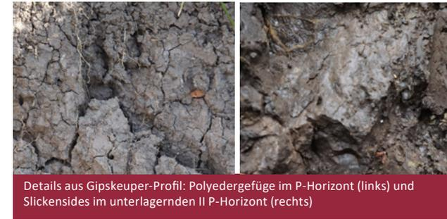
Details aus Gipskeuper-Profil: Polyedergefüge im P-Horizont (links) und Slickensides im unterlagernden II P-Horizont (rechts)
