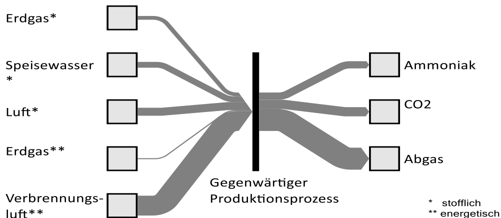
Abbildung 3-20: Sankey-Diagramm der aggregierten Massenbilanz für den definierten gegenwärtigen Produktionsprozess zur Herstellung von Ammoniak durch Dampfreformierung
