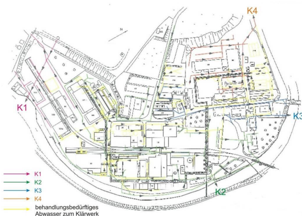
Anhang 6, Abb. 4: Abwasserplan mit Einleitungsstellen
