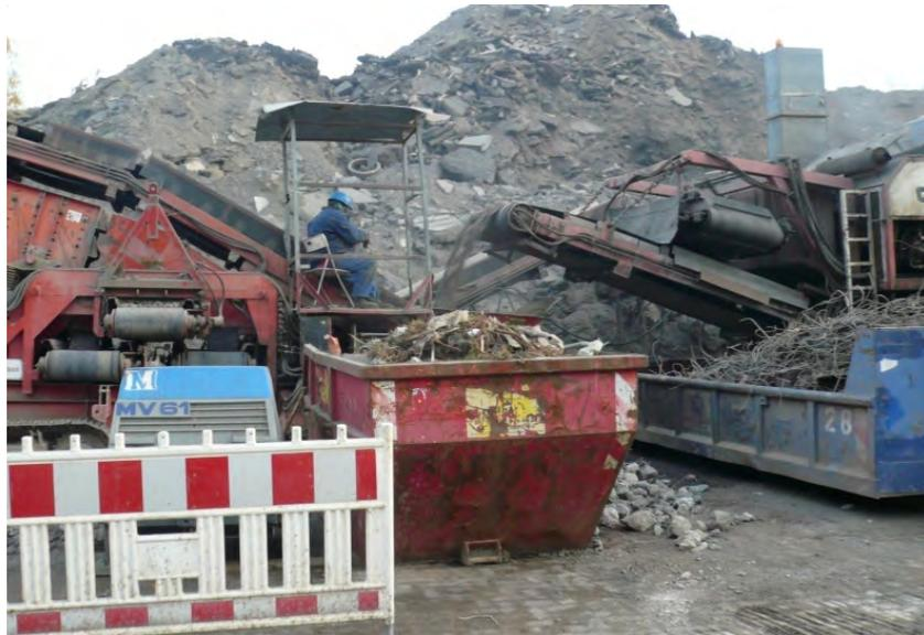
Abbildung 26: Brecherausgang mit anschließender Magnetabscheidung und Handsortierung
