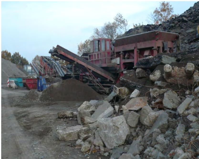
Abbildung 25: Aufgabeeinrichtung der semimobilen Bauschutt aufbereitungsanlage
