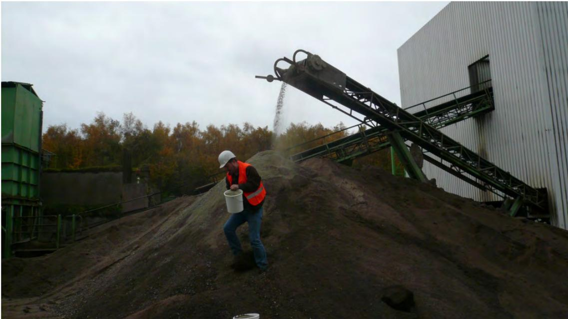
Abbildung 29: Austrag der RC-Brechsandfraktion 0/4 mm aus der Mehrwegsiebung
