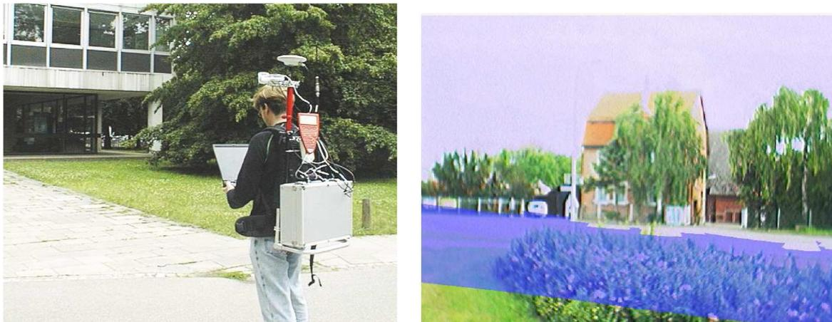
Abbildung 1: mAR-System zur Visualisierung von Hochwasserereignissen [Coelho, 2004]
