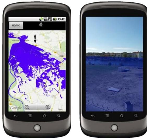
Abbildung 2: Hochwassergefahrenkarte in Kartenansicht (links) und in Kameraansicht als AR (rechts)
