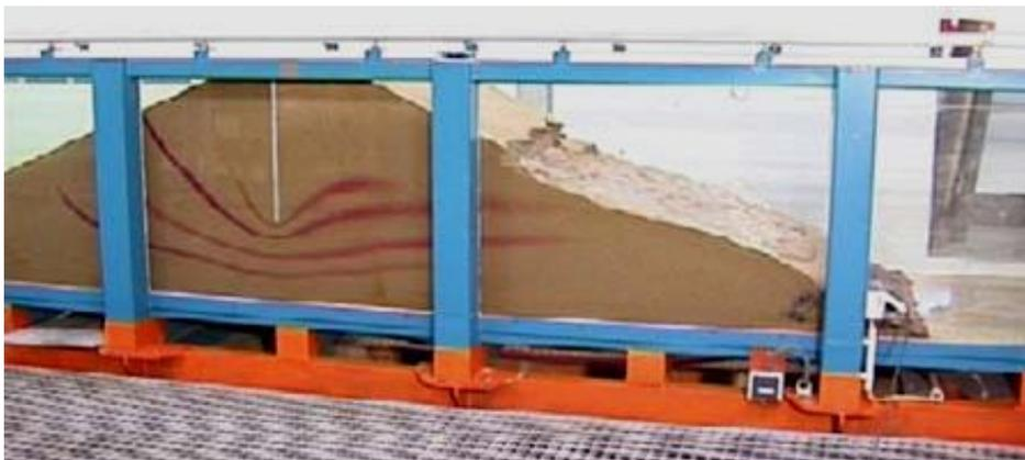
Abbildung 2. Ein physikalisches Damm-Modell mit Rutschung auf der Luftseite (Aigner, 2004)
