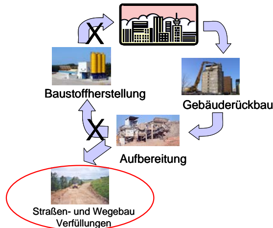
Abbildung 3.4: Downcycling von mineralischen Abfällen aus dem Hochbau
