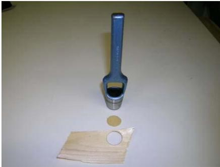
Abbildung 8: Aus einem Strand ausgestanzter Prüfkörper (22 mm) für Untersuchungen in der Micro-Chamber
