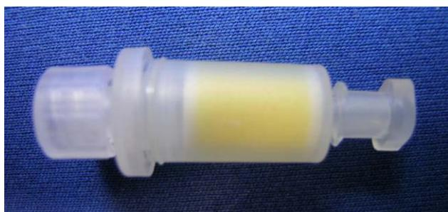
Abbildung 12: DNP-H-Probenahme-Kartusche für Aldehyde und Ketone
