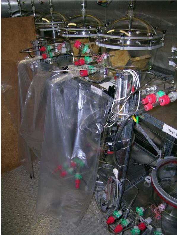
Abbildung 13: Anschluss der Tedlar-Behälter an die 23-l-Kammer
