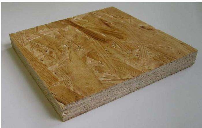
Abbildung 2: 3-schichtige OSB-Platte
