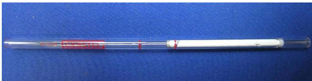
Abbildung 11: Tenax-Röhrchen für die Luftprobenahme
