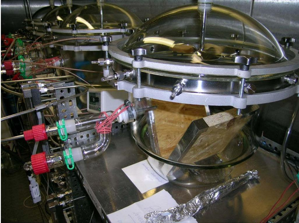
Abbildung 9: OSB-Platte in 24-l-Emissionsprüfkammer
