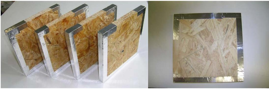
Abbildung 6: Abgeklebte Prüfkörper (9,6 cm offene Schmalfläche)
