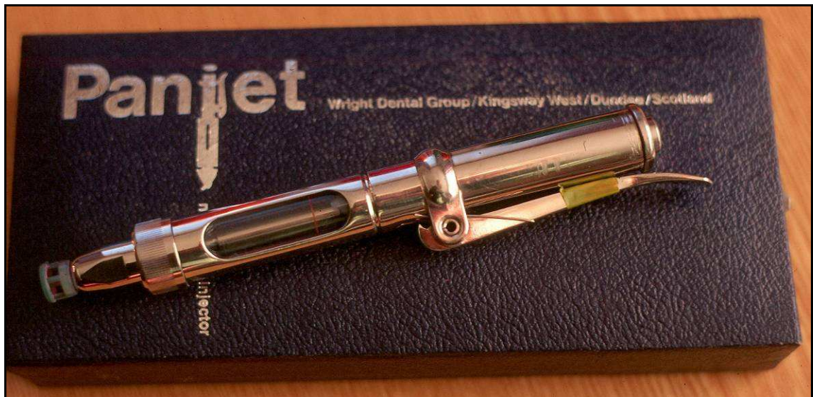
Abb. 15: Der Panjet, ursprünglich als nadelloses Injektionsgerät für medizinische Zwecke entwickelt, wird in der Fischereibiologie zur Markierung von Fischen genutzt
