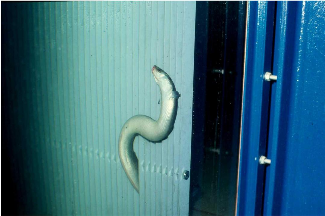
Abb. B. 2: Aal, der bei einer Anströmgeschwindigkeit  $> 0,5$  m/s an einen 20 mm-Rechen angepresst wird (ARBEITSGEMEINSCHAFT GEWÄSSERSANIERUNG 1998)
