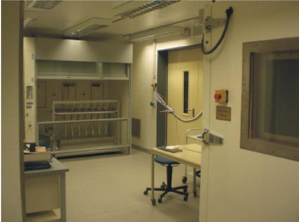
**Abbildung 4-28: Mobiler Vergleichsmaßstab und 5 m<sup>3</sup>-Kammer mit Bewertungstrichter**
