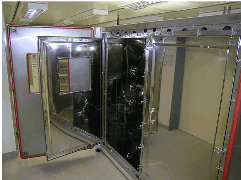
**Abbildung 4-8: 5 m<sup>3</sup>-Kammer mit geöffneter Tür**
