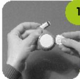
1. Bei dem runden Sammler **entfernen** Sie bitte den **Befestigungsring mit der weißen Membran** (eventuell mit einer Münze). Den Befestigungsring mit der weißen Membran können Sie wegwerfen.
