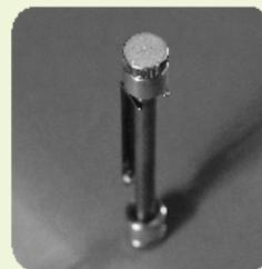
Die Innenraumluft wird mit diesen drei unterschiedlichen Sammlern (rund, viereckig und röhrenförmig) erfasst, die im Wohnraum z. B. an einer Lampe befestigt sind. Die Probenahmezeit beträgt 7 Tage.
