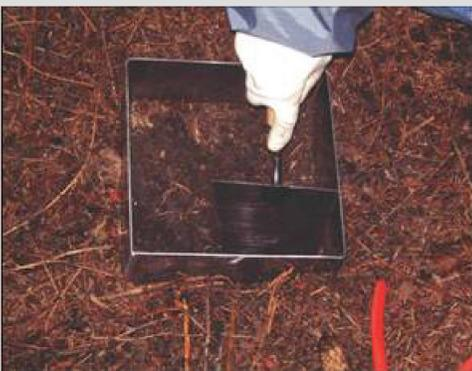
2. Probenahme von Ober- und Unterboden mit dem Split-Tube-Sampler
