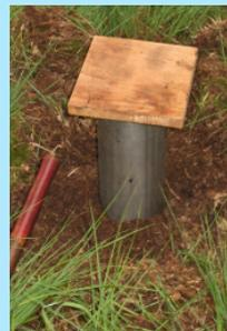
Abb. 7: Entnahme einer Torfsäule
