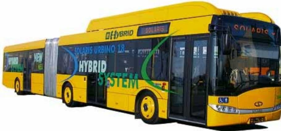
Das hier eingesetzte Allison-Hybridantriebssystem kombiniert im Urbino 18 Hybrid die Arbeit eines Verbrennungsmotors mit einem Elektroantrieb. Dank seiner Steuerung arbeitet der Motor die gesamte Zeit über im optimalen Kennlinienbereich und sein Leistungsüberschuss lädt während der Fahrt die Batterien auf. Durch diese Technologie ist auch eine Rückgewinnung der Bremsenergie des Fahrzeugs und ihre Speicherung in speziellen Batterien möglich (vgl. Abb. 29).
