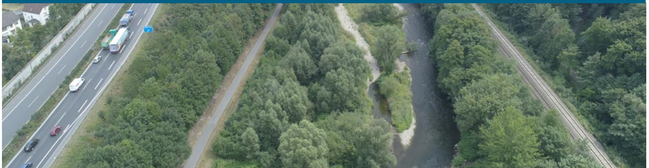
In Binnerfeld durchfließt die Ruhr eine 100-200 m schmale Aue, die zwischen Autobahn und Bahnstrecke verläuft. Trotz dieser massiven Flächenrestriktionen konnte man der Ruhr hier in Teilbereichen mehr Eigendynamik zugestehen. Durch teilweises Entfernen der Ufersicherungen, flächige Absenkung der Ufer und ein Anheben der Sohle wurde der Fluss auf einer Länge von rund 3,5 km wieder stärker in Kontakt mit der umgebenden Talau gebracht.
