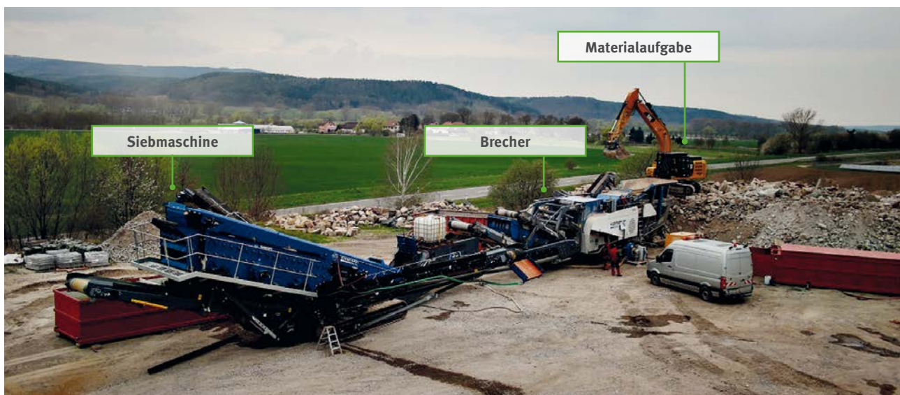
Ansicht einer mobilen Bauschuttauflaufbereitungsanlage
