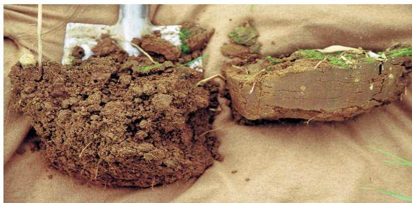
Bild 46: lockerer (links) und in einer Fahrspur verdichteter Boden
