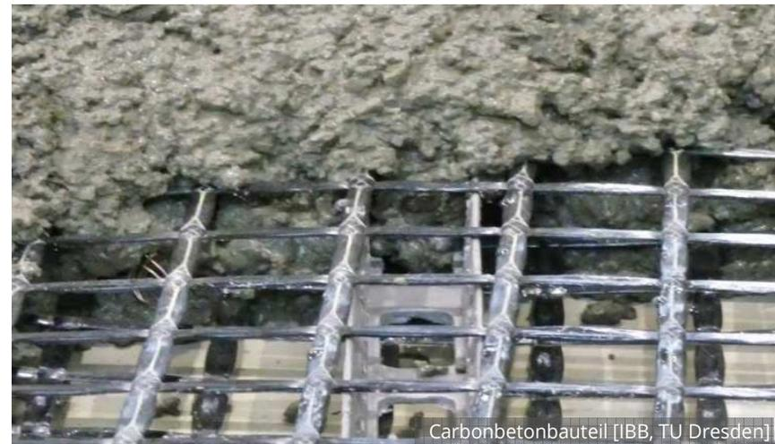
Carbonbetonbauteil [IBB, TU Dresden]
