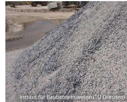
Ergebnis: C<sup>3</sup>-Betonrezyklat 0/16 mit Carbonfasern
