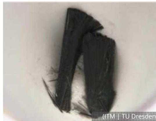
Einzelprobe nach der Pyrolyse
