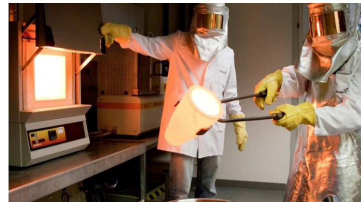
Ausgießen eines glaskeramischen Markers bei Polysecure
