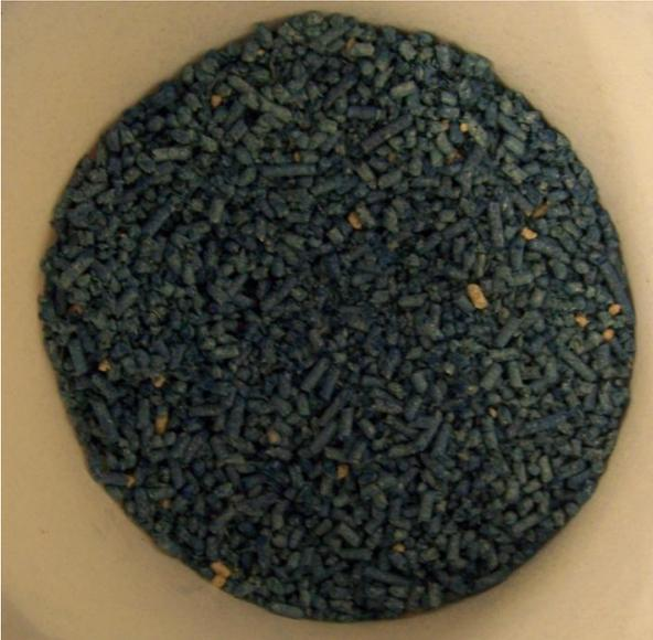
Abbildung 12: Blau eingefärbte Holzpellets aus dem Vorversuch zu den Untersuchungen in der Hochdrucktemperaturpelletieranlage mit *S. endobioticum* (Foto: Yvonne Schleusner, JKI)
