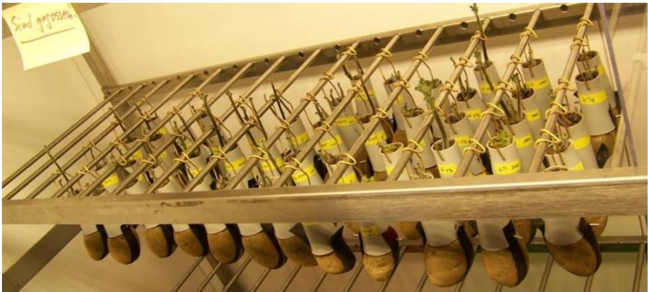
Abbildung 14: Kartoffeln im Tuben-Test zur Überprüfung der Vitalität bzw. Virulenz der Dauersori. Die Kartoffeln sind über ein schwarzes Gummiband fest an den Tuben fixiert. Die Tuben (weiße, leicht konisch zulaufende Plastik-Zylinder) sind mit einem Gemisch aus gedämpfter Komposterde und Krebskompost befüllt. (Foto: Yvonne Schleusner, JKI)
