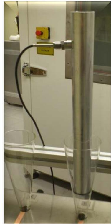
**Abbildung 2.1 links: Strömungsrohr mit eingefasstem Hitzdrahtanemometer; rechts: Strömungsrohr bei der Anwendung im Geruchstrichter**
