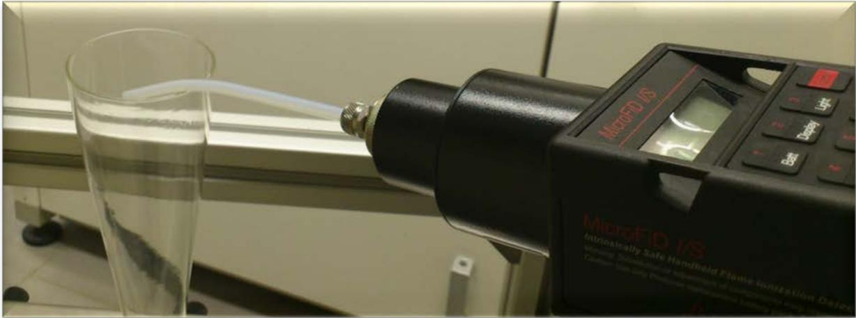
**Abbildung 2.2 Bestimmung Acetonkonzentration mit einem mobilen FID (Fa. Photovac®)**
