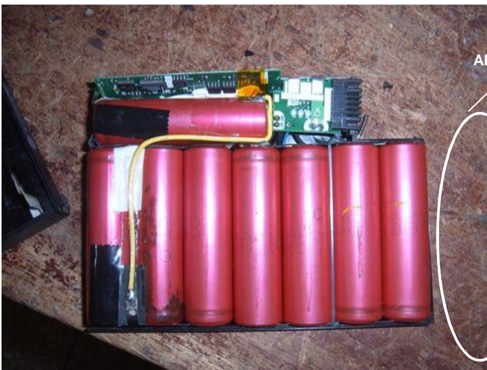
Abbildung 14 Wiederaufladbare Lithium-Batterie eines Notebooks (Öko-Institut 2011)
