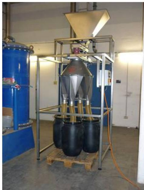
Abbildung 3: Drehrohrprobenteiler
