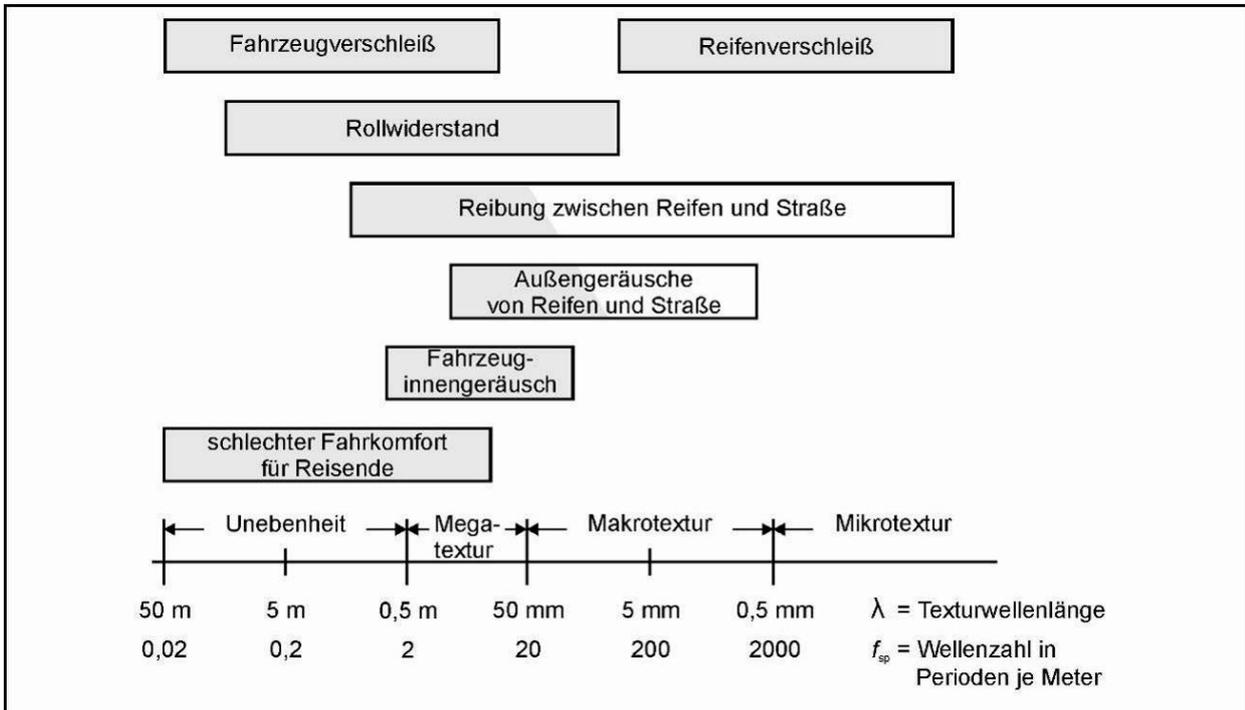
Anmerkung: Ein heller Hintergrund bedeutet eine erwünschte Auswirkung der Textur in diesem Bereich, während der dunkle Hintergrund eine unerwünschte Auswirkung anzeigt. Quelle: [DIN EN ISO 13473-1]
