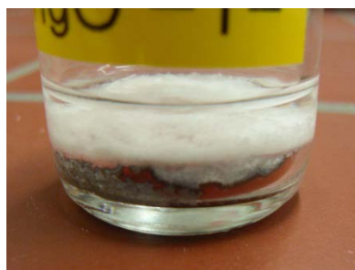
Abb. 9: Bildung eines Magnesiumhydroxid-Niederschlags beim Kontakt von HgO mit IP21-Lösung
