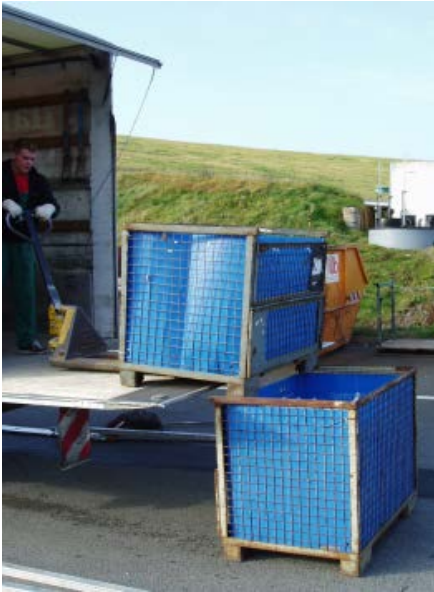
Abb. 23: Behälterstapelung mittels Hubwagen und Ladebordwand (Bildquelle: INTECUS)
