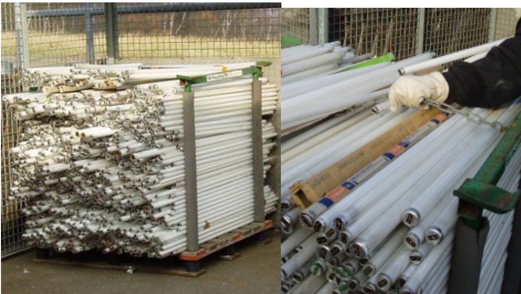
Abb. 25: Schlechte Stapelung von Leuchtstoffröhren auf Rungepaletten (Bildquelle: INTECUS)
