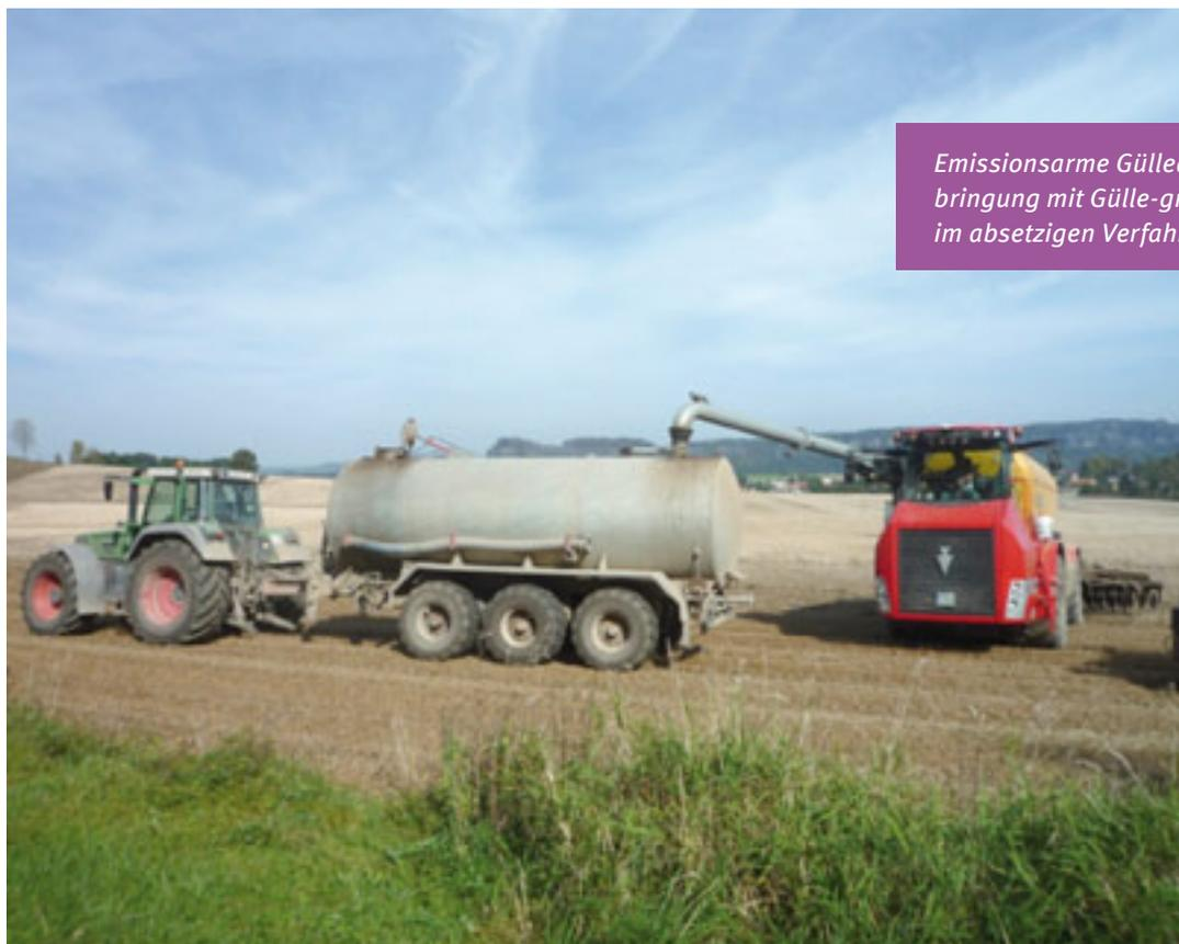
*Emissionsarme Gülleausbringung mit Gülle-grubber im absetzigen Verfahren*
