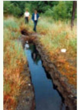
**Mitarbeiter des Umweltbundesamtes untersuchen das Gelände eines WGT-Standortes. Der Wasserzulauf im Vordergrund ist durch Treibstoffe und Schmieröle schwer kontaminiert. Ein Test an der Wasserpumpe zeigt: die Flüssigkeit brennt sogar.**
