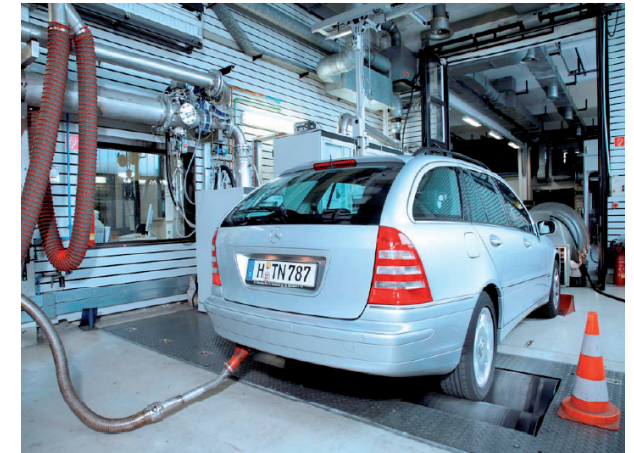
Auto auf Abgasprüfstand Quelle: TÜV Nord
