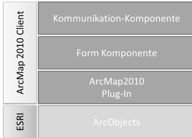
Abbildung 2: Aufbau des ArcMap Clients
