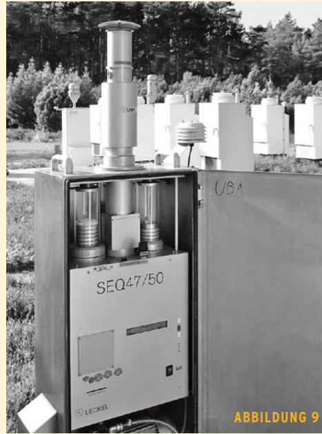
Zwei unterschiedliche Sammelgeräte für Feinstaub. Oben sind die Abscheider erkennbar, die selektiv nur Partikel bis zu einer maximalen Größe passieren lassen ( PM_{10} , PM_{2.5} oder PM_1 ). Die Abkürzung PM steht hierbei für „Particulate Matter“ (= partikuläre Bestandteile), die englische Fachbezeichnung für Feinstaub, die tiefgestellte Zahl für die Obergrenze der Partikelgrößenfraktion in \mu m (Mikrometer = Millionstel Meter bzw. Tausendstel Millimeter).
