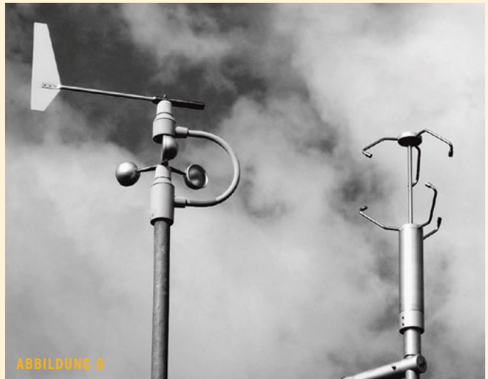
Schalenanemometer (links) und Ultraschallanemometer (rechts), die klassische und die moderne Variante zur Messung von Luftbewegungen, wie zum Beispiel Windrichtung und Windstärke.
