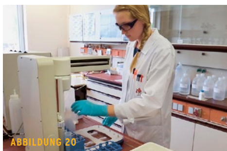
Die Laboratorien in der Messnetzzentrale Langen analysieren Feinstaub- und Niederschlagswasserproben auf Ionen, Schwermetalle, Quecksilber, Kohlenstoffspezies und POP. Mittels der unten dargestellten Atomfluoreszenzspektrometrie werden Niederschlagswasserproben auf ihren Quecksilbergehalt analysiert. Die Konzentrationen liegen im Bereich weniger Nanogramm (Milliardstel Gramm) pro Liter.
