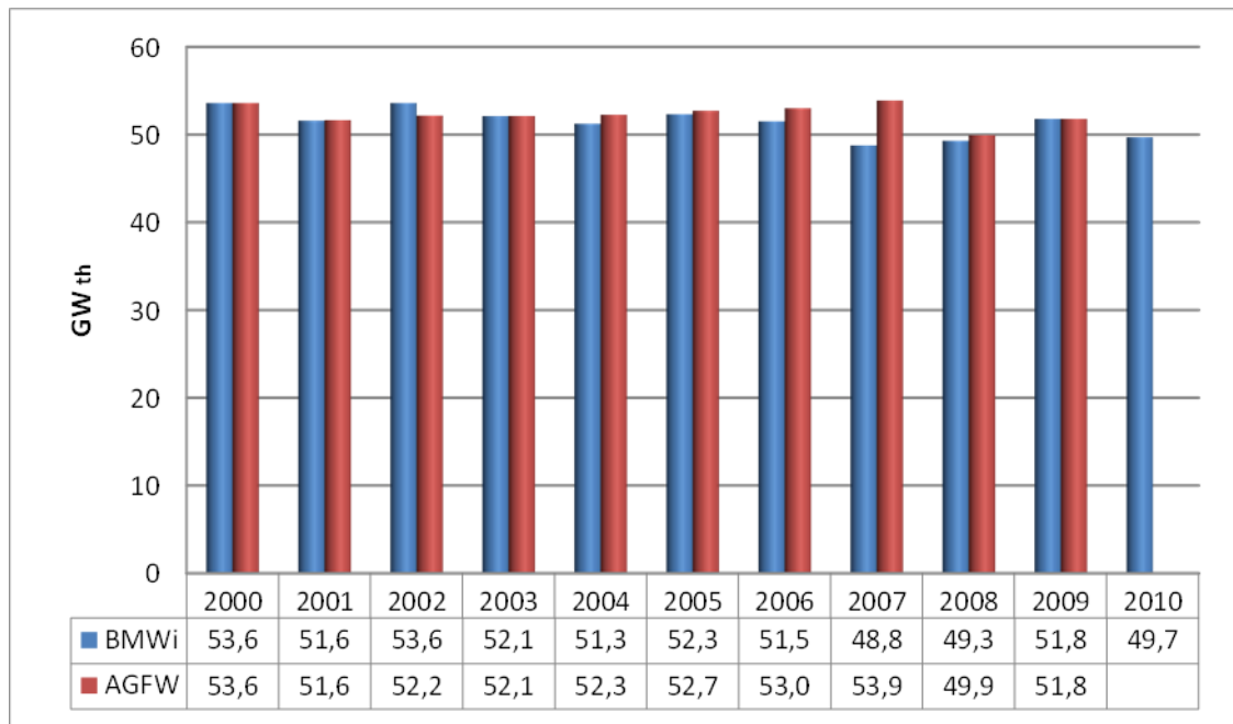
Abbildung 5-1 Installierte Wärmeleistung für Fernwärme; Gegenüberstellung der Angaben von AGFW und BMWi, 2000-2010
