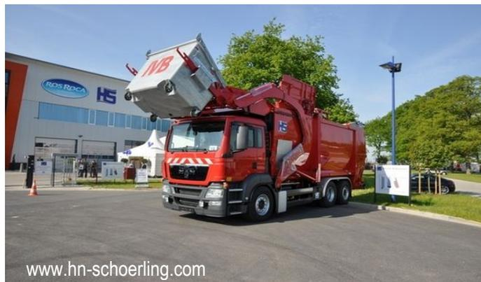
Рис. 11: грузовик с передней загрузкой
