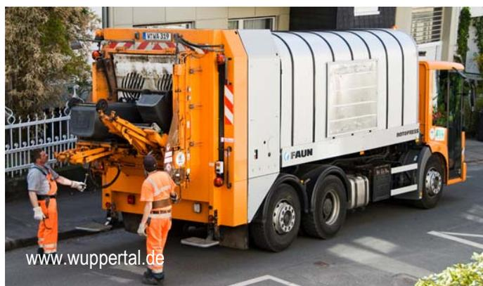
Рис. 9: грузовик с задней загрузкой
