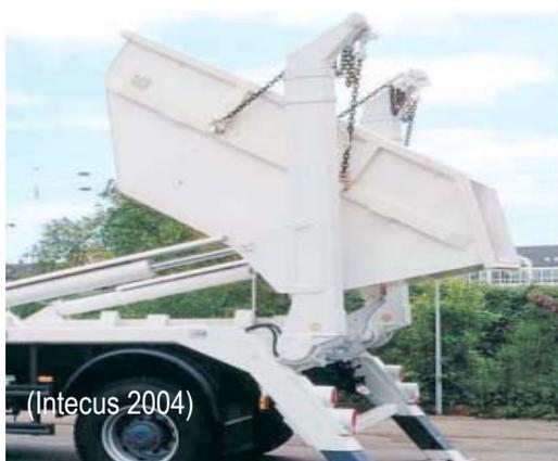
Рис. 6: Базовая версия скип-контейнера в момент опрокидывания
