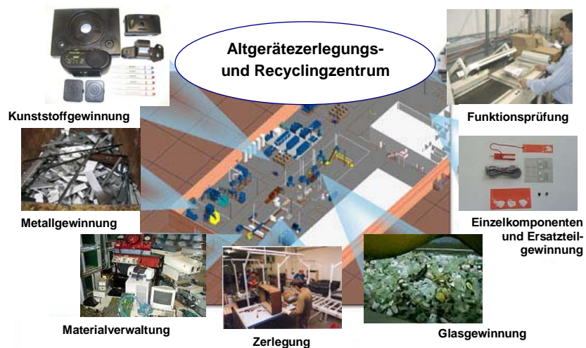
Abb.3: Prozesskombination in einem Altgerätezerlegungsbetrieb
