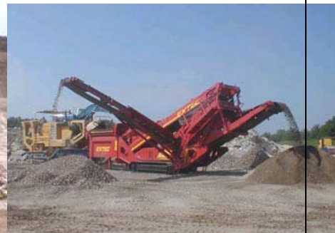
Abb. 4: Klassierung von Mineralgemischen mit Extec® Aggregat
