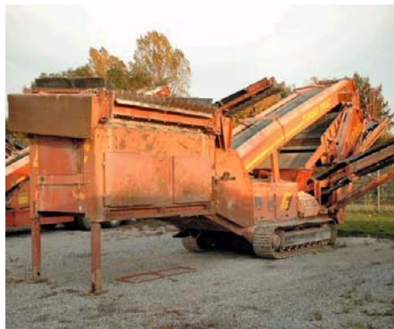
Abb. 1: Mobile Siebanlage für Bauabfälle
