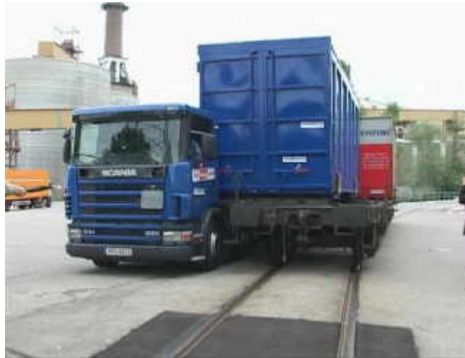
Abb.4: Horizontal-Umschlagtechnik für Wechselbrücken (im Bildbeispiel: System der Firma Palfinger Bermüller)
