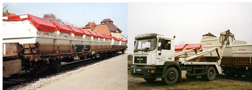
Abb.6: System mit bahnverladbaren Absetzcontainern (im Bildbeispiel: System der Firma AWILOG)
