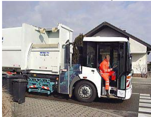
Abb.3: Unechter Seitenlader mit in den wechselbaren Sammelbehälter integrierter Schüttung (Bildquelle: www.ries-pressen.de )
