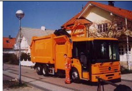
Abb. 2: Unechter Seitenlader mit Wechselaufbau (Bildquelle: www.ries-pressen.de )
