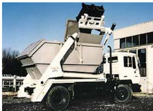
Abb. 5: Sonderkonstruktion: Seitenlader am Absetzkipper (Bildquelle: www.duenschede-fahrzeugbau.de )
