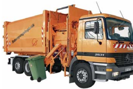
Abb. 1: Echter Seitenlader mit Wechselaufbau (Bildquelle: www.otto-environment.com )
