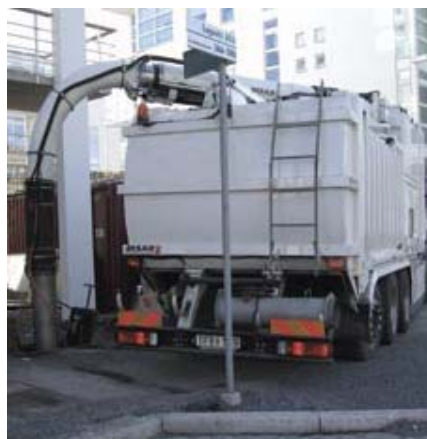
Abb.3: Saugfahrzeug bei der Entleerung eines Bunkers (Bildquelle: www.envac.de )
