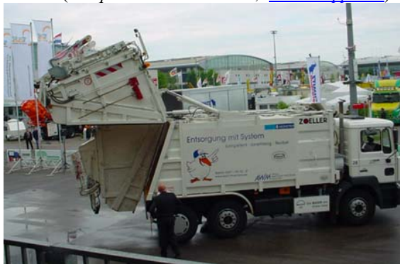
Abb. 2: Zweikammerfahrzeug zur parallelen getrennten Sammlung von 2 Fraktionen mit geöffneter/geschlossener Schüttwanne (Bildquelle: Intecus GmbH)
