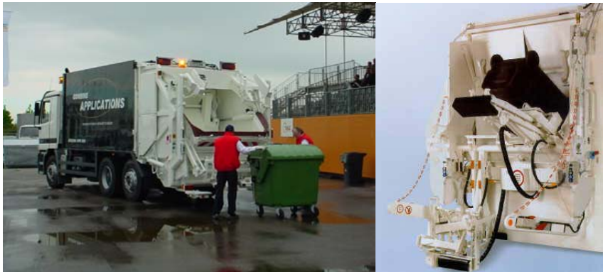
Abb. 1: Standardfahrzeug mit Kammschüttung/Automatikschüttung mit geteiltem Lifter (Bildquellen: Intecus GmbH; Zöller-Kipper.de )
