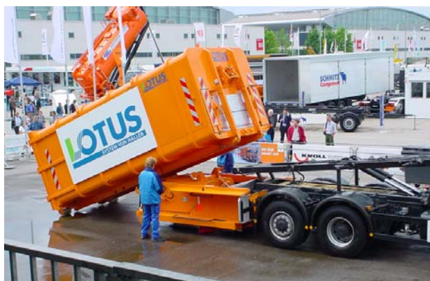
Abb. 5: Hecklader beim Absetzen eines Wechselbehälters (Bildquelle: Haller Umweltsysteme GmbH & Co KG)
